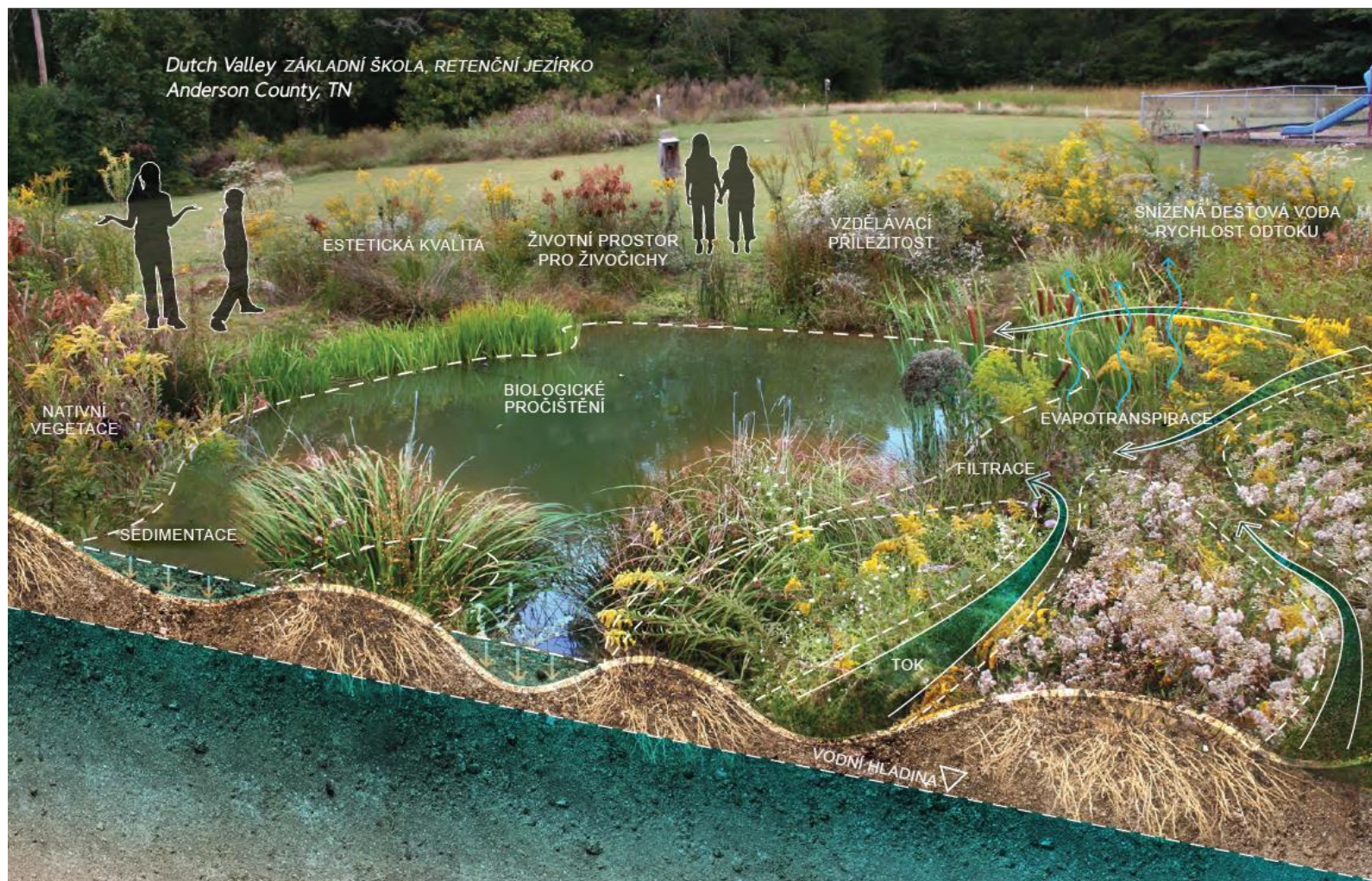
Obr. 1. Retenční nádrž zrealizovaná v základní škole, (Převzato a upraveno: Matlock & Morgan, 2011)
